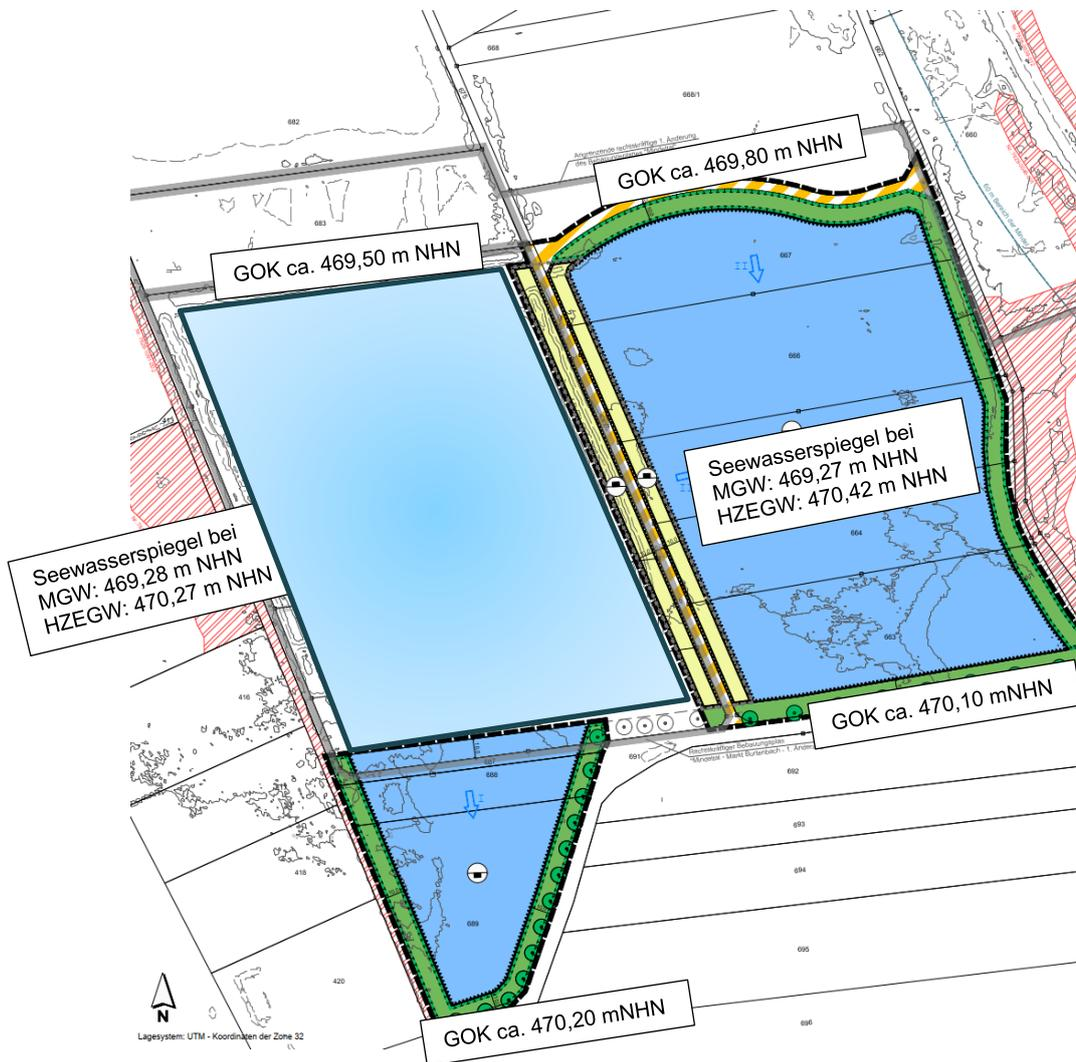
Abb. 5: See- und Grundwasserspiegelhöhen (MGW/HZEGW) der Variante A während des Kiesabbaus
