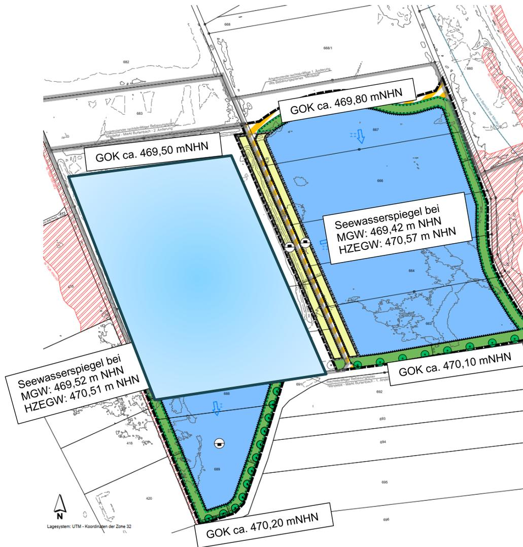
Abb. 8: See- und Grundwasserspiegelhöhen (MGW/HZEGW) der Variante A nach der Re-
