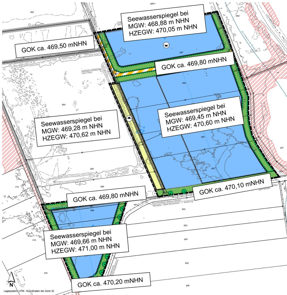
Abb. 9: See- und Grundwasserspiegellagen MGW/HZEGW der Variante B nach der Re- kultivierung
