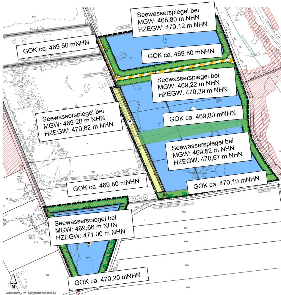
Abb. 10: See- und Grundwasserspiegellagen (MGW/HZEGW) der Variante C nach der Rekultivierung
